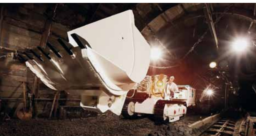
Bild 1: Lader der Hazemag & EPR im Einsatz bei der RAG im deutschen Steinkohlenbergbau
