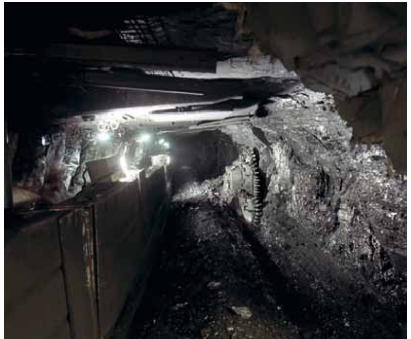
Bild 2: Hobel und Strebaubau von Caterpillar im Einsatz auf Ibbenbüren Foto: Caterpillar
