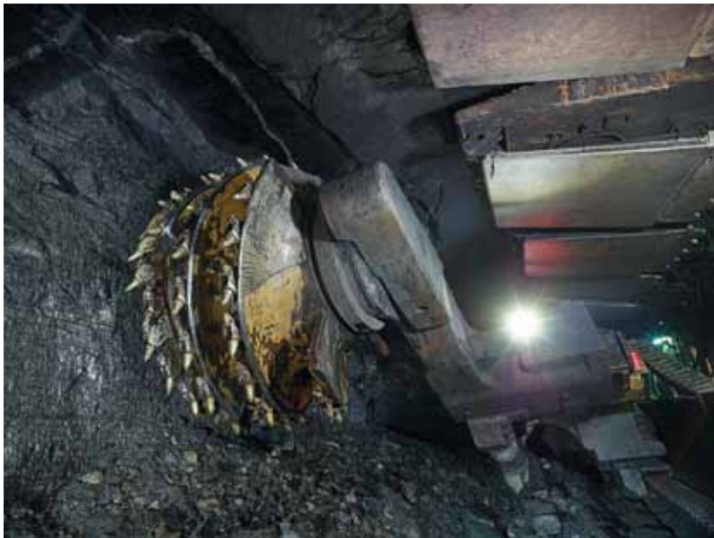
Bild 3: Eickhoff-Walzenlader im Einsatz bei der RAG im deutschen Steinkohlenbergbau Foto: Dietmar Klingenburg
