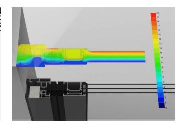
Die **thermische Trennung** des neu entwickelten und **patentierten Torstockprofils** reduziert die Wärmeverluste und minimiert das Kondensieren der Raumluft an der Torinnenseite.
