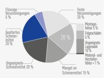
80 % der Getriebeschäden sind auf mangelhafte Schmierung bzw. fortgeschrittene Ölalterung zurückzuführen und sind vermeidbar.
