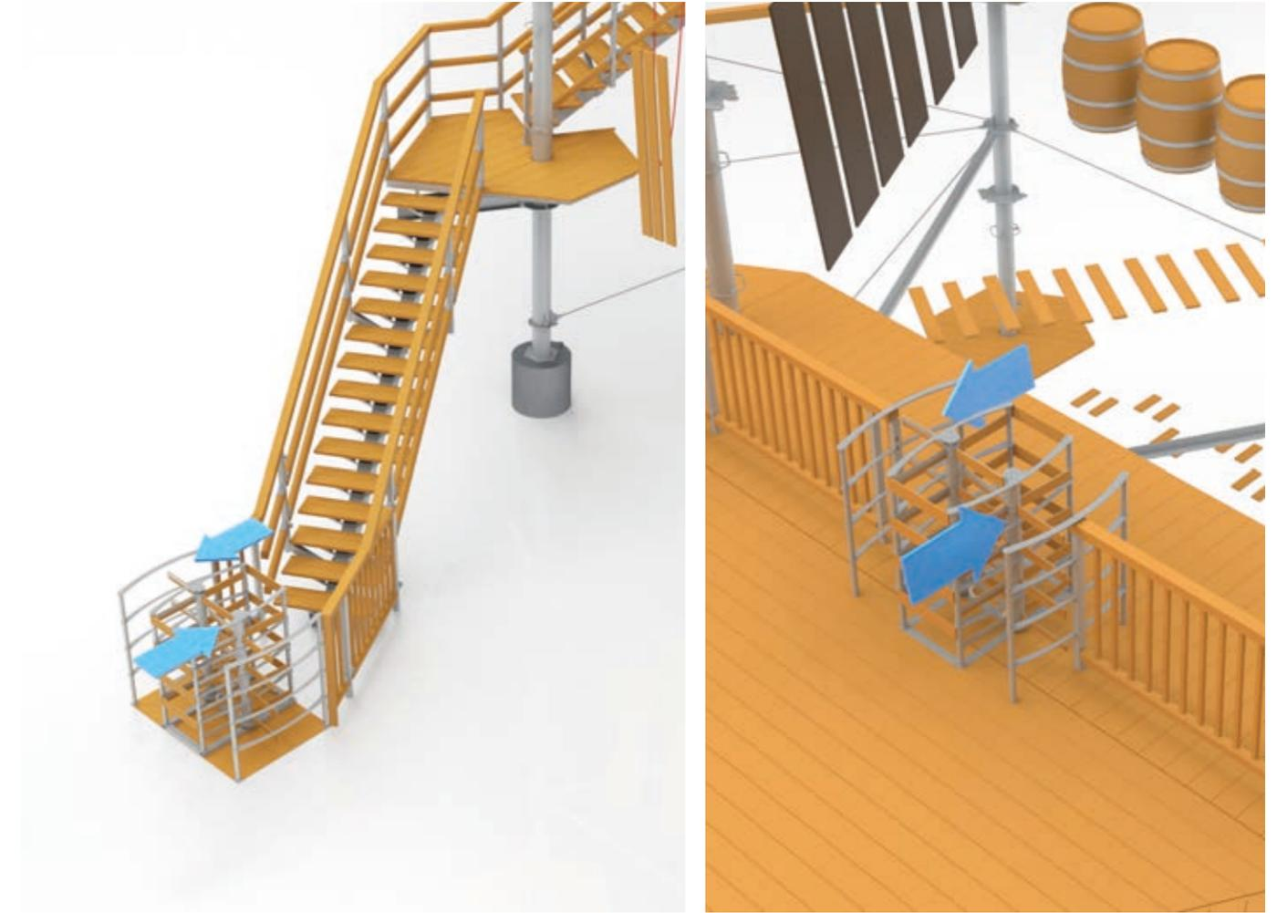
Die Zugangskontrolle stellt sicher, dass nur Teilnehmer, die richtig im Sicherungssystem eingehängt sind, den Kletterbereich betreten können. Erst nachdem beide Sicherungskarabiner im Sicherheitsseil eingehängt sind, gibt die Drehtür für eine Person den Durchgang frei. Diese kann sich dann gesichert und selbstständig im Kletterbereich bewegen. Nicht oder nicht richtig gesicherte Teilnehmer und Gäste ohne Klettergurt bekommen keinen Zugang.
