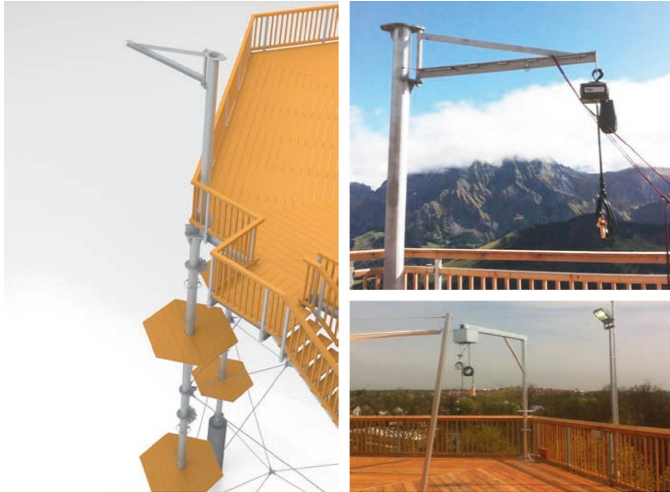
Mit dem Lastenkran können große Mengen und schwere Materialien einfach und bequem auf die Plattform gehoben und herabgelassen werden. Das erleichtert besonders die Vorbereitung und Durchführung von Veranstaltungen in luftiger Höhe.
