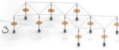
Durch die Verbindung von Dreiecken kann jede beliebige Form kreiert werden. Zum Beispiel kompakte Sechsecke oder längliche Strukturen.
