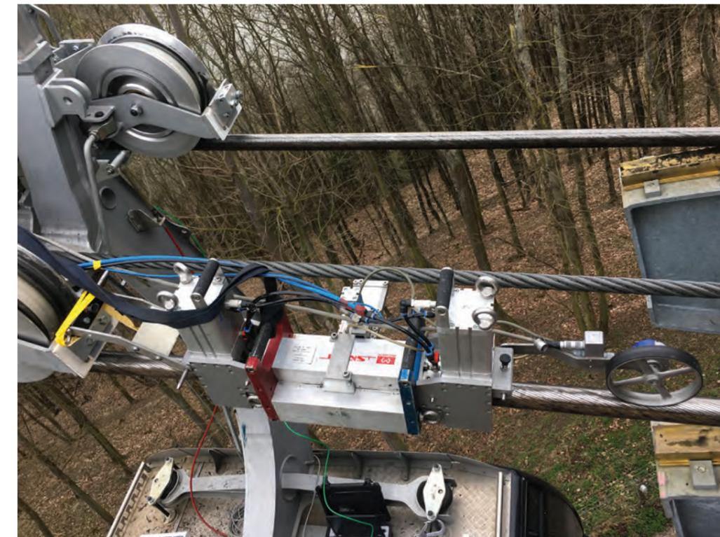
Tragseilprüfung mit dem magnetinduktiven Seilprüfgerät SMRT 60 mit Abhebevorrichtung
