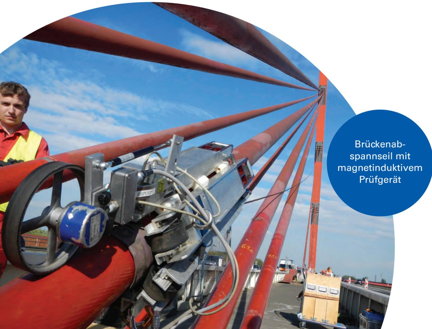
Brückenabspannseil mit magnetinduktivem Prüfgerät
